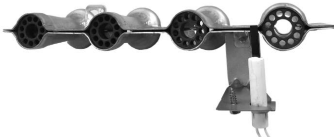
Fig. 5 : Vue côté flamme de la position correcte de l'allumeur
